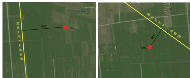
图1 风电机组与埋地天然气长输管道相对位置示意图
