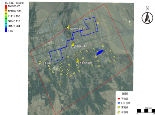
图5 非正常工况后新厂区原料罐石油类运移情况
