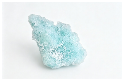
图2 脱戊烷塔空冷管束结晶铵盐
