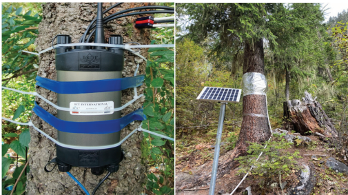
图1 径流仪及太阳能供电系统
