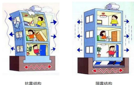
图 2 抗震结构与隔震结构遭遇大地震时的区别
