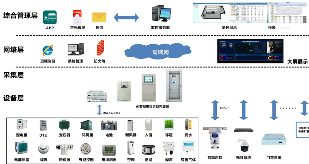
图 2 变电站远程控制示意图
