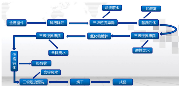
图 2 镀锌工艺流程图
