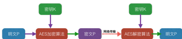
图 4 AES 加密算法示意图
