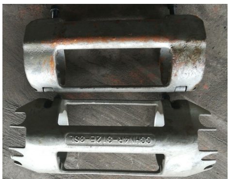
图 4 改进型扁电缆护罩与老式电缆护罩对比图
