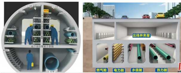
图1 综合管廊剖面图
