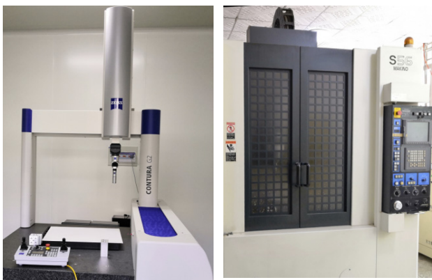
图4 三坐标测量机和数控机床的实体测量与加工环境
