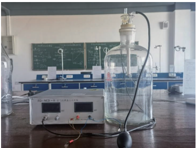
图1 空气比热容比实验的实验装置
