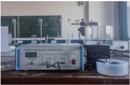
图3 液体表面张力系数测定实验的实验装置
