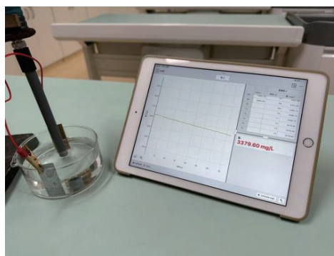
图2 用氯离子传感器测定铜片附近氯离子浓度变化
