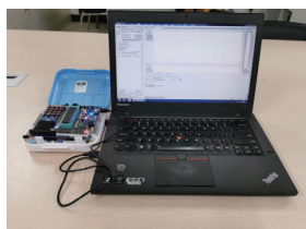
图3 《单片机原理与应用》口袋实验室-便携式单片机开发套件
