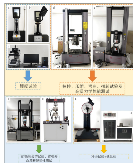
图1 实验中心力学性能检测设备对应试验示意
