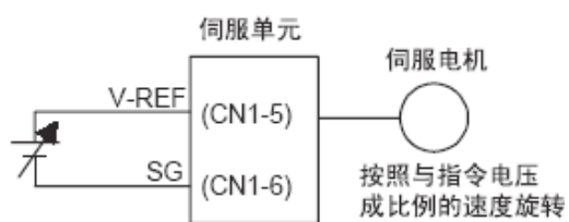
图 5 伺服电机速度控制接线图
