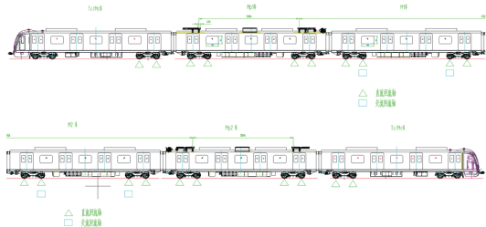
图11 车辆交流、直流工况下的回流轴设置示意图
