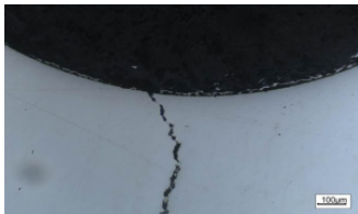
图15 紧邻开裂处的横截面（放大） 腐蚀后，组织为铁素体 + 部分珠光体，见图 16、图 17。
