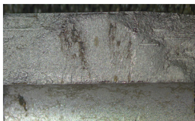
图2 裂纹打开后的断口、匹配断口
