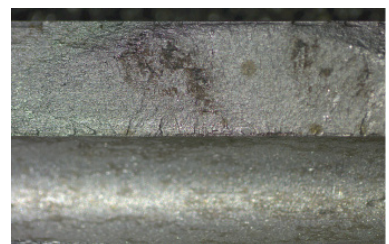
图4 断口稍放大后的形貌
