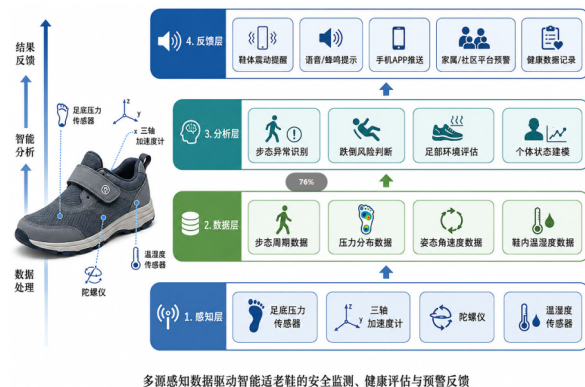
图1 智能适老鞋多模态感知系统架构
