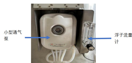
图4 通气装置实物图
