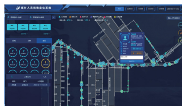
图4 井下人员精确定位系统
