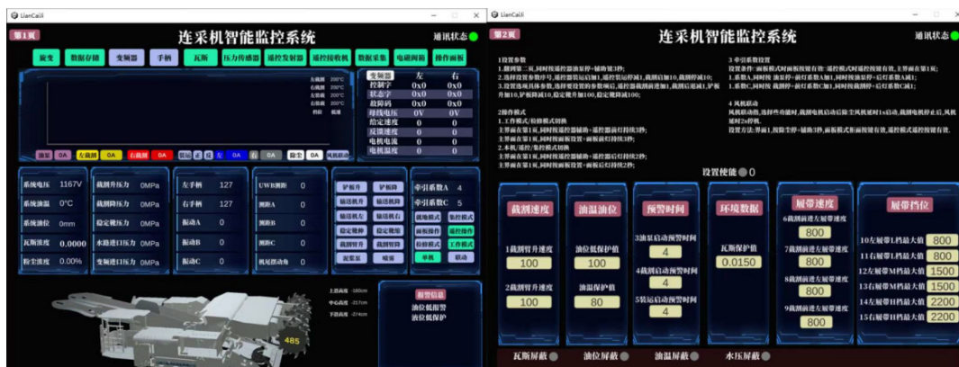
图 7 连续采煤机机载监控系统
