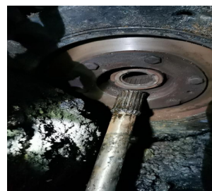
图 3 运输链轮断裂
