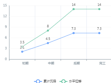
图1 地铁车站沉降与水平位移曲线图
