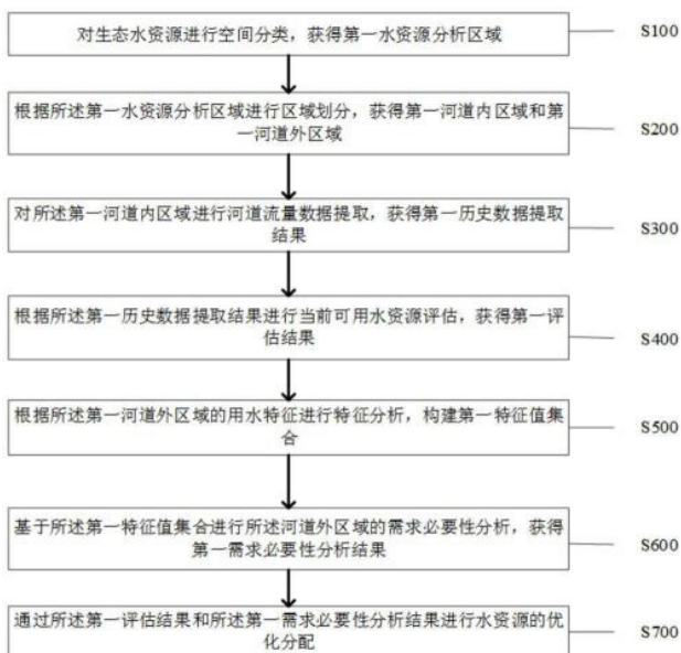
图 1 基于生态的水资源优化配置方法的流程示意图
