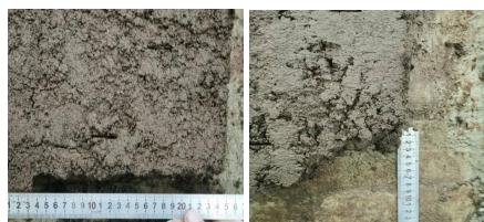
图7 5%水泥含量土体局部掉落 图8 11%水泥含量土体局部掉落
