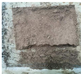
图5 0%水泥含量土体下方边缘掉落
