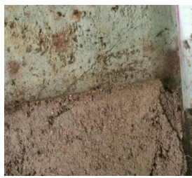
图6 0%水泥含量土体整体下滑
