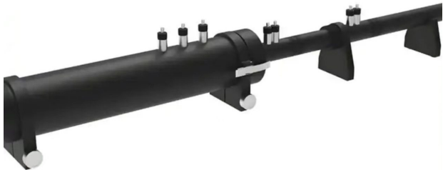
图5 阻抗管测试原理与设备实物：（a）测试原理；（b）标准大阻抗管；（c）标准小阻抗管
