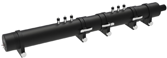
图5 阻抗管测试原理与设备实物：（a）测试原理；（b）标准大阻抗管；（c）标准小阻抗管
