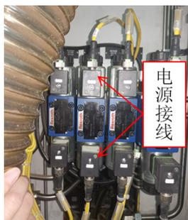
图 8 电磁阀电源接线
