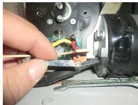
图 2 雨刷器电机复位触指均存在烧损现象
