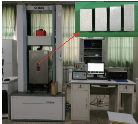
图 2 150℃下压缩实验及温度控制系统
