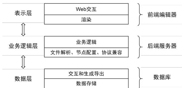
图 2 便捷编辑工具架构
